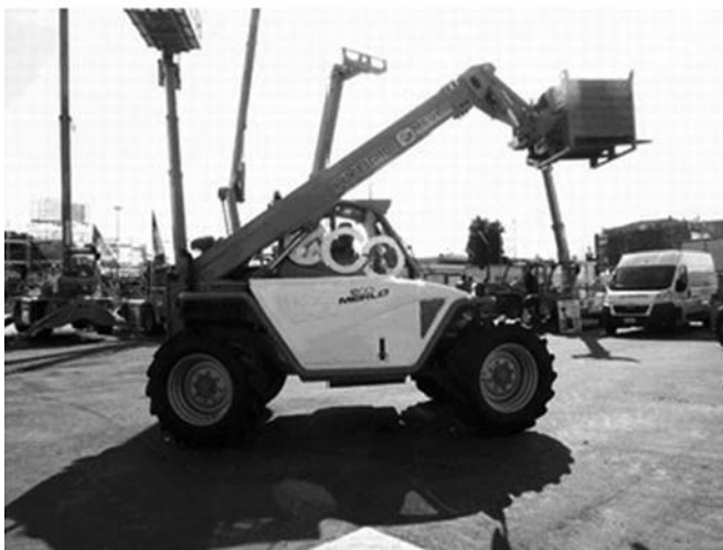
Рис. 1. Телескопический погрузчик фирмы Merlo
